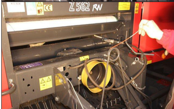
Держатель направляющих гидравлических шлангов и электропроводов при присоединении к трактору.
