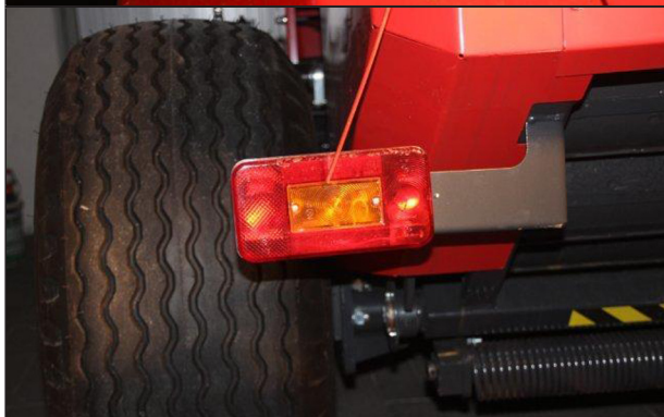
Осветительная лампа сзади машины. (комбинированная: указатель поворота, стоп-сигнал, габаритный огонь).
