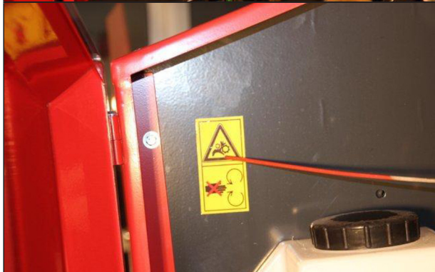
Предупреждающая пиктограмма! Не открывайте и не снимайте защитных крышек во время работы машины.
