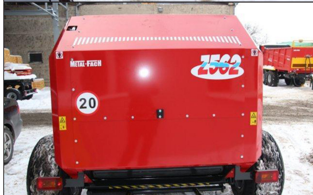
Рулонный пресс-подборщик Z562 Задняя часть машины и расположение пиктограмм.
