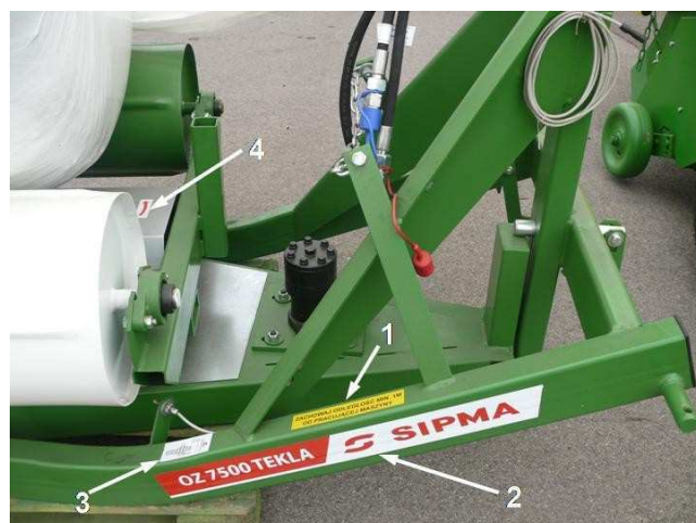
Рис. 16. Размещение наклеек – вид с правой стороны обмотчика: 1 – пиктограмма информационная; 2 – наклейка OZ 7500 L; 3-способ установки счетчика обмоток; 4 – направление оборотов.
