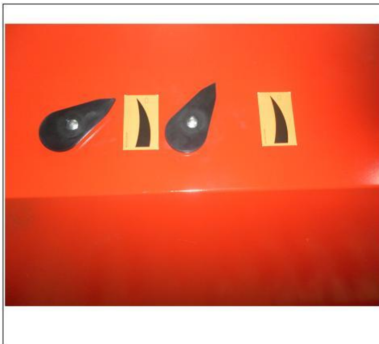
Рис.7. Индикатор уровня наполнения (имеет также цифровую индикацию уровня наполнения).
