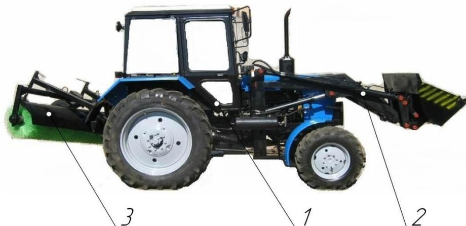
Рисунок 2. Общий вид и комплектация Снегопогрузчиков ПФС-0,75Б-2 и ПФС-0,75БКУ-2
