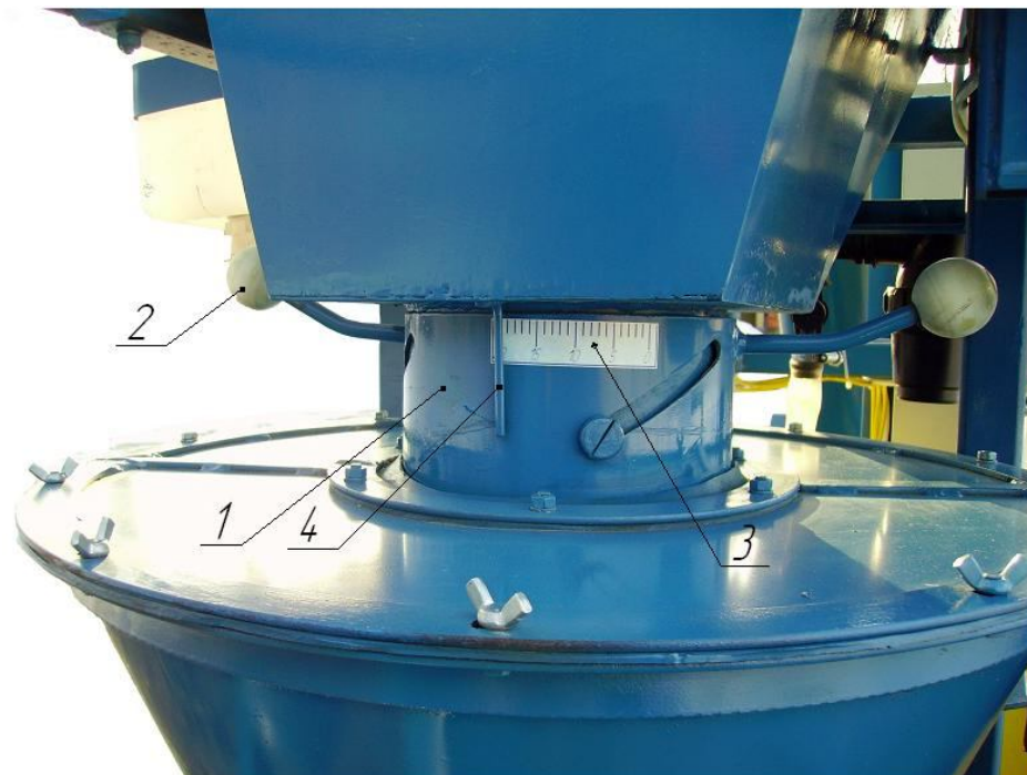
Рис. 8. Регулировка производительности по зерну.
