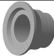
ЛДГ-10М.05.004 Катужка упорная Материал: СЧ20.м = 1,02 кг.
