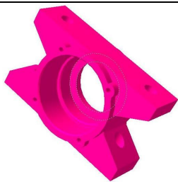
ЛДГ-10М.05.005 Корпус под-ка Материал: СЧ20. m = 4,8 кг
