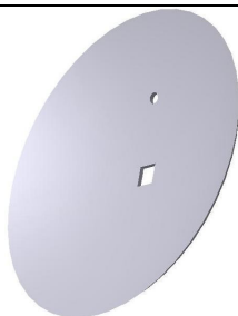
ЛДГ-10М.05.001 Диск Материал: Ст65Г.м = 7,35 кг.
