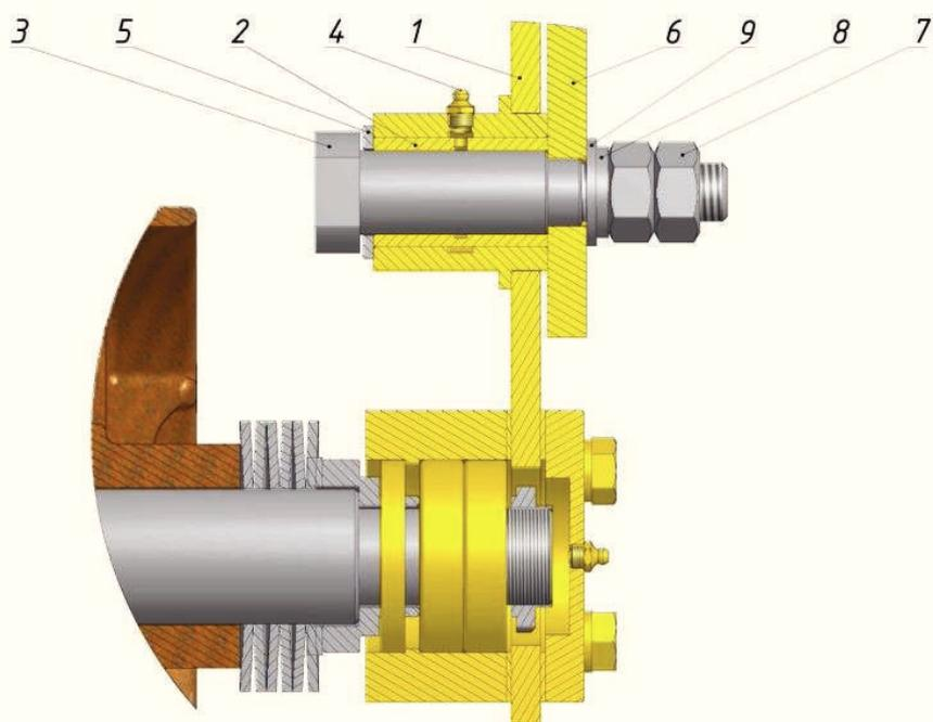
**Рисунок 8 – Шарнир подвеса центральной секции**
