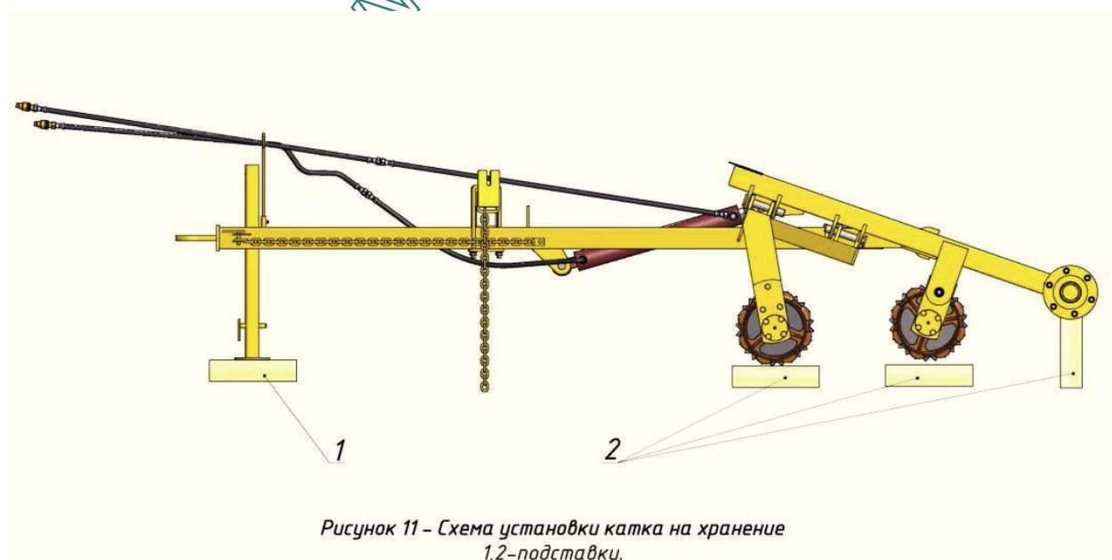
**Рисунок 11 – Схема установки катка на хранение**
