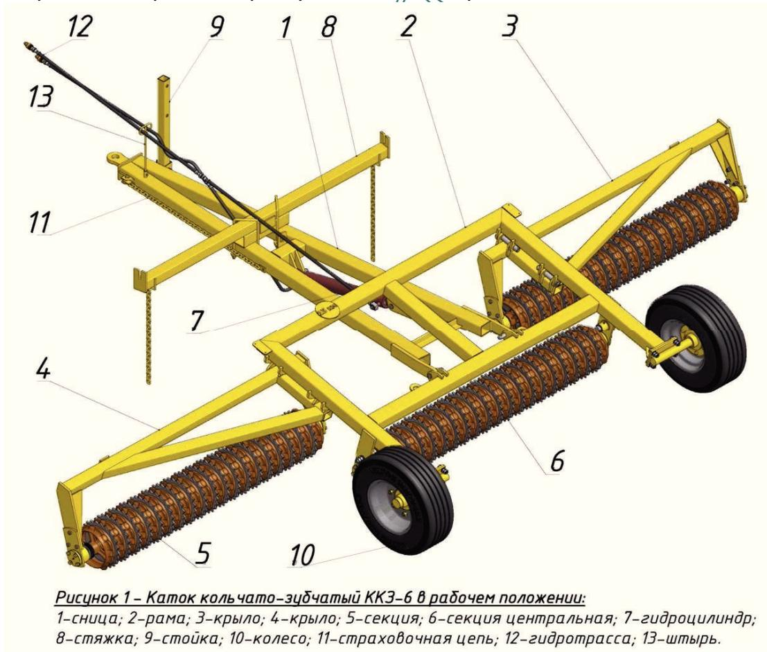
*Рисунок 1 – Каток кольчато-зубчатый ККЗ-6 в рабочем положении:
