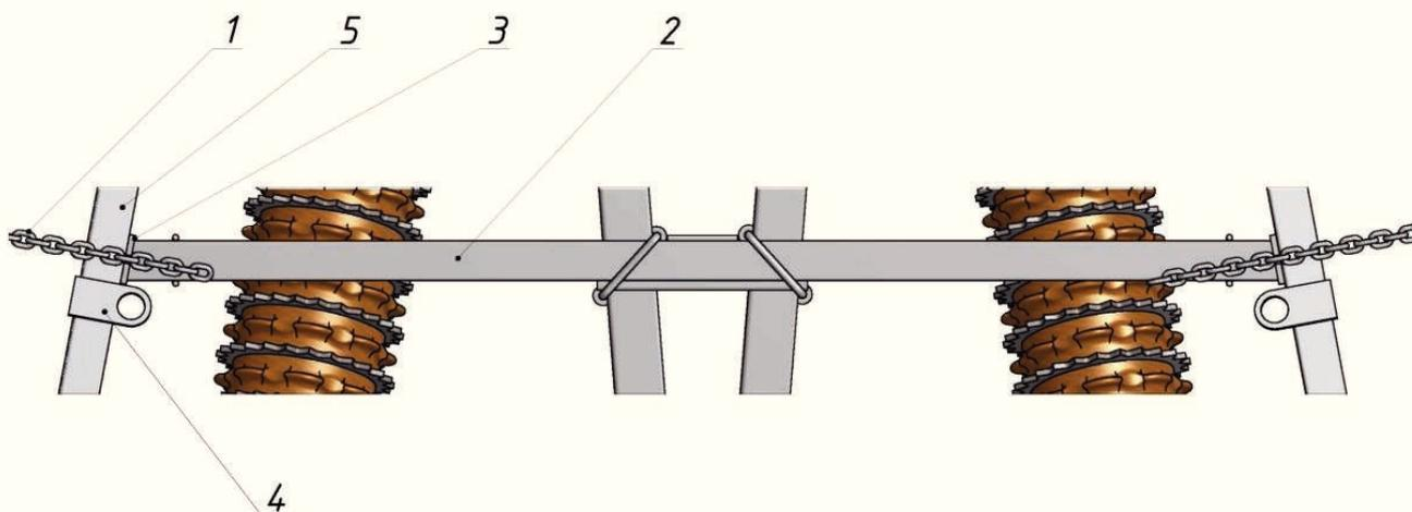
**Рисунок 2 – Фиксация крыльев в положении дальнего транспорта**
